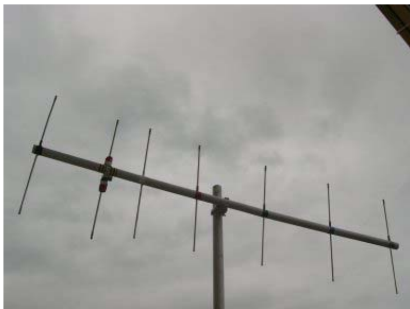
10. L'antenna UHF montata in polarizzazione verticale
