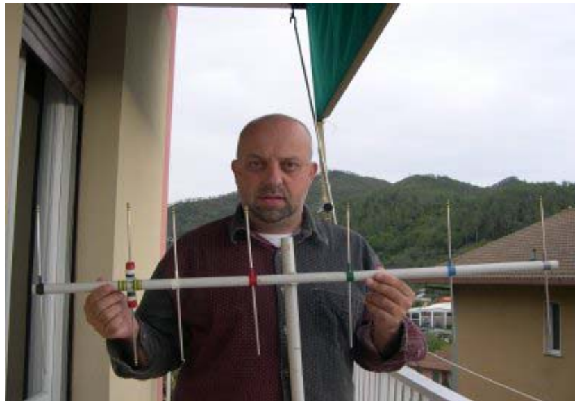
9. Ecco la nostra antenna completa di tubo di supporto
