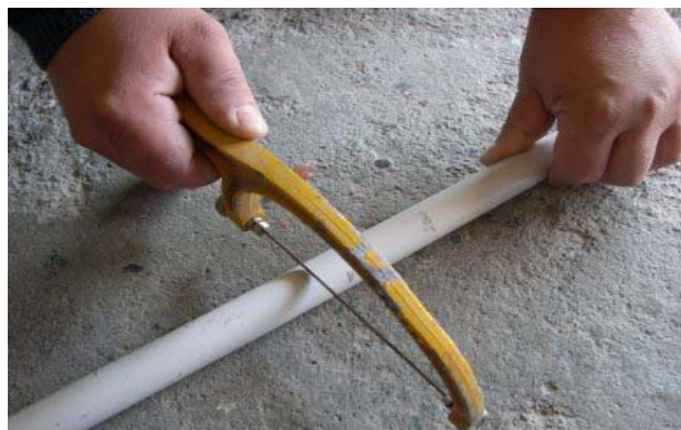
1. Cominciamo a tagliare il tubo di plastica e lasciamo quello che resta da parte per un successivo utilizzo
