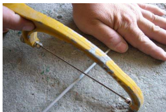
2. Passiamo al taglio dei tubicini di alluminio che serviranno per produrre il dipolo, il riflettore e i vari direttori
